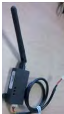
Radioadapter voor de binnenunit die op het betreffende elektronische bord moet worden aangesloten.
