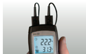
Gelijktijdige temperatuuraflezing van twee aangesloten voelers en verschiltemperatuur weergave
